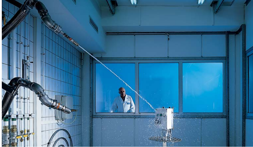
Испытания на степень защиты
